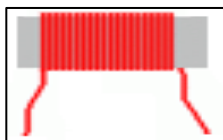
Figura 88. Inductor de 600 vueltas
