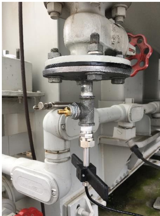
Figura 33. Sonda introducida en la válvula
