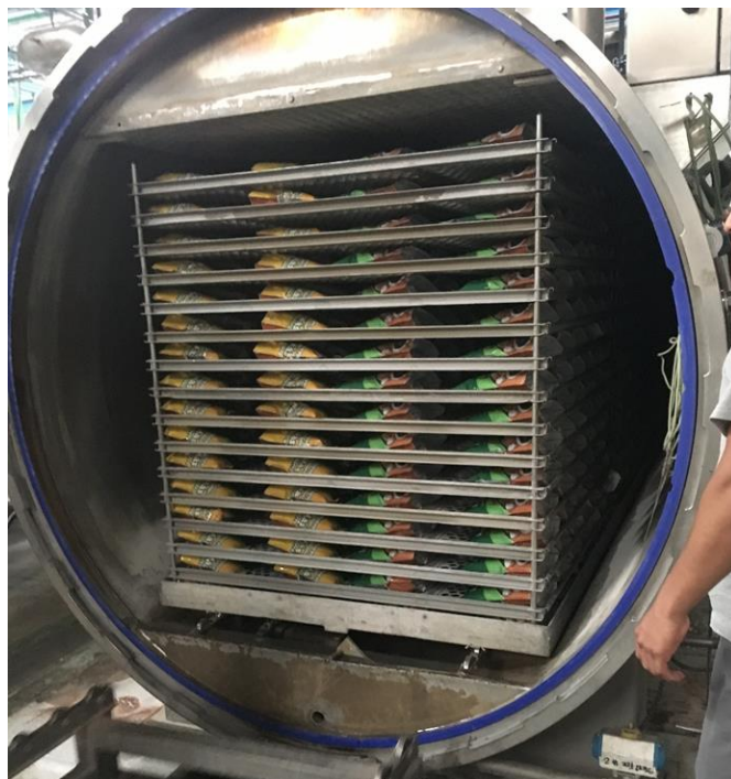
Figura 32. Chequeo de las condiciones del empaque de la puerta de la autoclave #4
