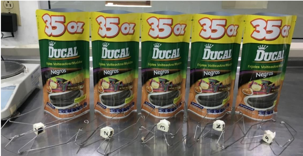
Figura 44. Set de loggers preparados para prueba de toma de lecturas de temperatura, durante proceso de esterilización
