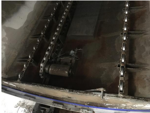
Figura 46. Carril para carretas de autoclave, con logger sujeto para pruebas
