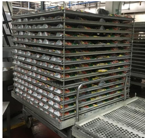
Figura 45. Carreta de autoclave Sterifer, con muestras con loggers
