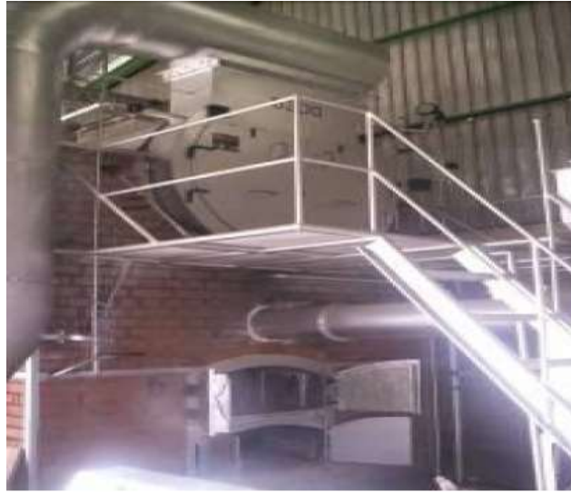
Figura 2. Modificación del hogar para la quema de biomasa
