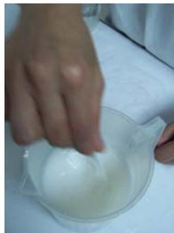
5. Ya disuelto el hidróxido de calcio se agrega en el tanque, como se indica más adelante y se vuelve a verificar el  $\text{pH}$ . Agitándolo por 20 minutos a 40 rpm. (ver Figura 15.)
