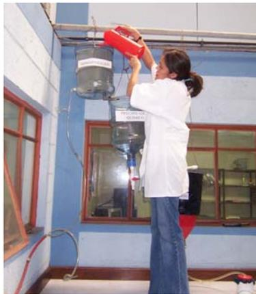
3. Una vez lleno el tanque, se iniciará con la aireación del efluente. El proceso de aireación del tanque, deberá de ser de por lo menos 2 horas al día a 15 psi. (ver figura 10.)
