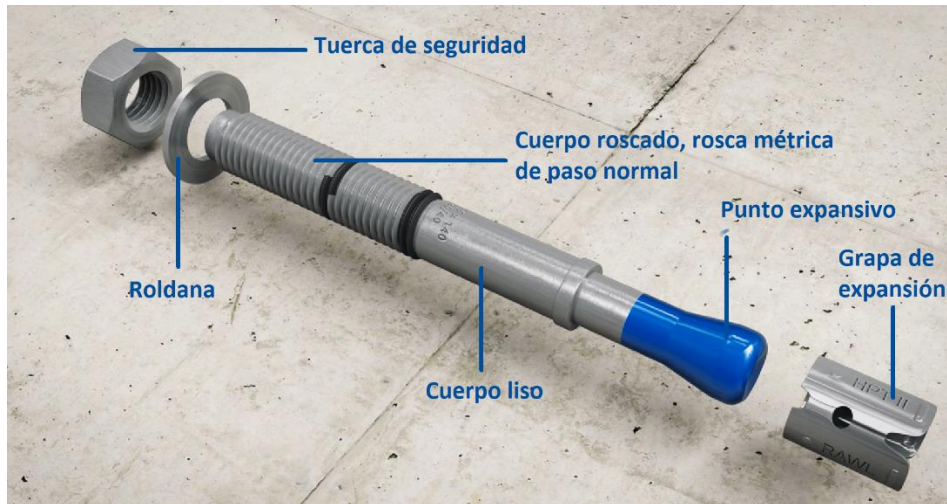
Figura 20. Elementos mecánicos del tornillo de anclaje de expansión
