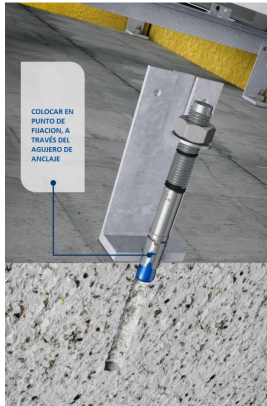
Figura 21. Fijación en anclaje de bases de equipos
