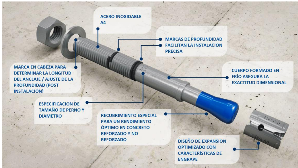
Figura 19. Características del tornillo de anclaje de expansión
