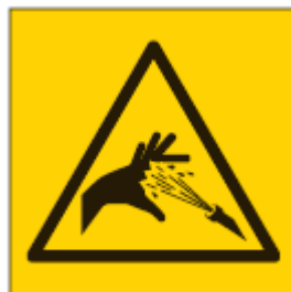
Figura 24. Fluido hidráulico a presión
