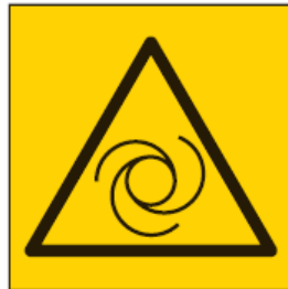
Figura 32. Aviso de componente de máquina, puesto en marcha
