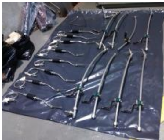
Figura 24. Desmontaje, revisión y limpieza de tubería de alta presión y válvulas antiretorno (checks)
