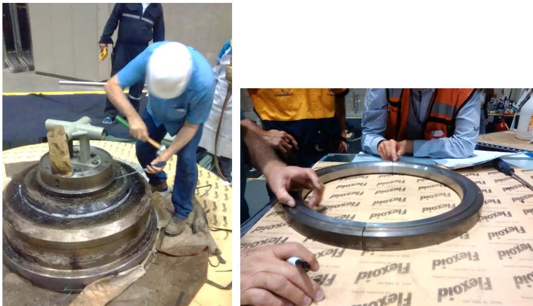
Figura 101. Extracción de anillo de empuje
