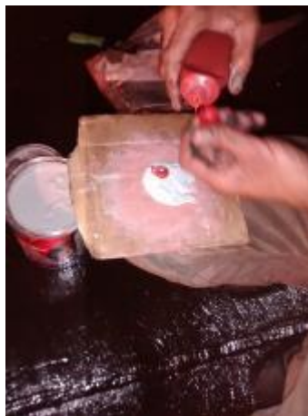
Figura 69. Preparación de mezcla epóxica de secado rápido para toma de muestra
