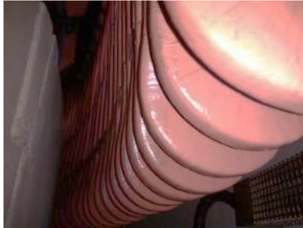
Figura 56. Cabeza de bobina después de dar limpieza y mantenimiento
