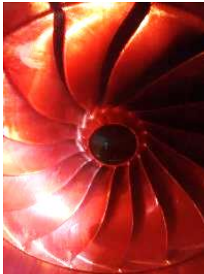
Figura 73. Ensayo no destructivo con líquidos penetrantes
