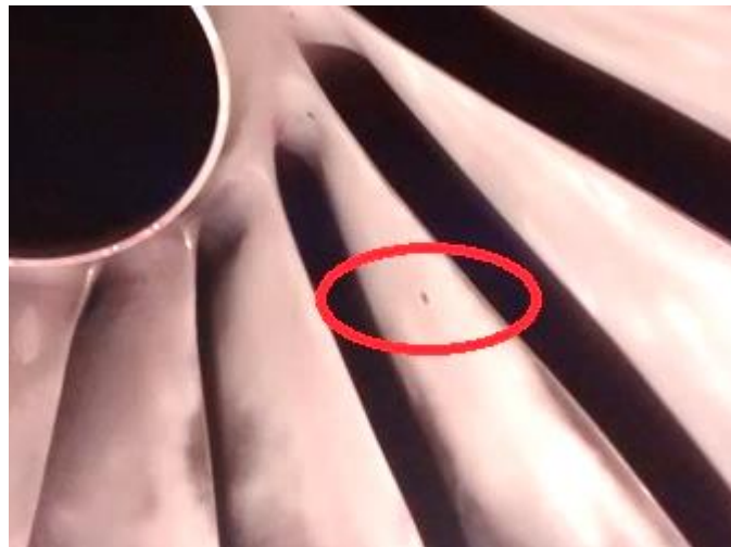
Figura 75. Muestra de daños en rodete después de aplicar revelador
