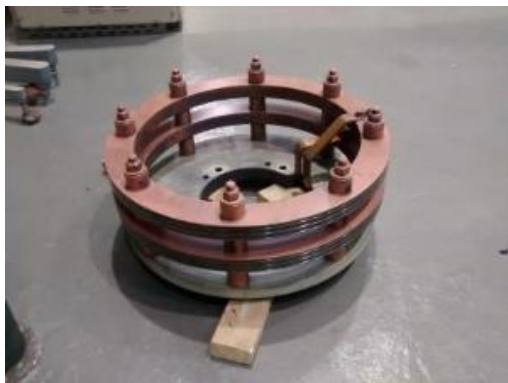
Figura 16. Desmontaje de anillos colectores
