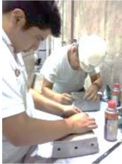
Figura 29. Rasqueteado de cojinetes radiales (pads) para la disminución de ralladuras en babbitt
