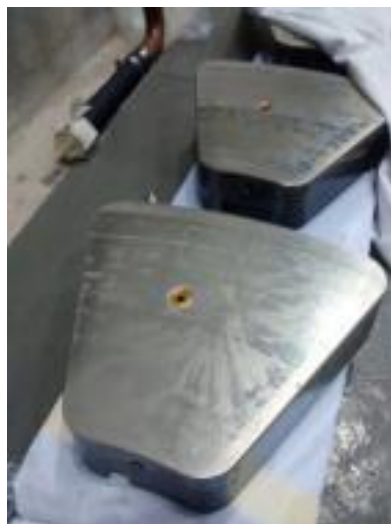
Figura 26. Desmontaje de cojinetes (pads) axiales
