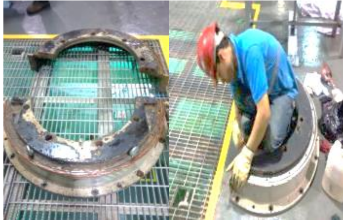
Figura 85. Desmontaje y limpieza de tapa del sello mecánico
