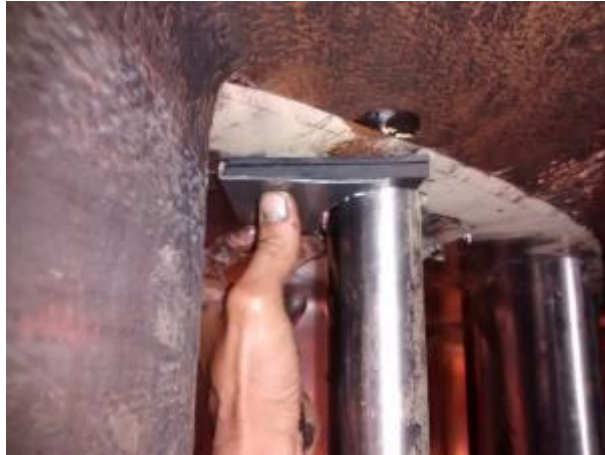
Figura 70. Toma de muestra, sección superior de álabe directriz
