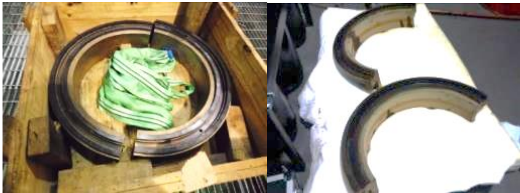
Figura 86. Limpieza de sello mecánico de repuesto
