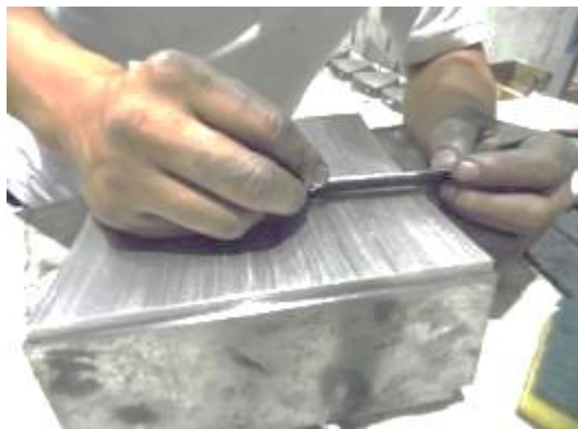
Figura 46. Revisión de estado y rasquetado de cojinetes radiales para la disminución de ralladuras en babbitt
