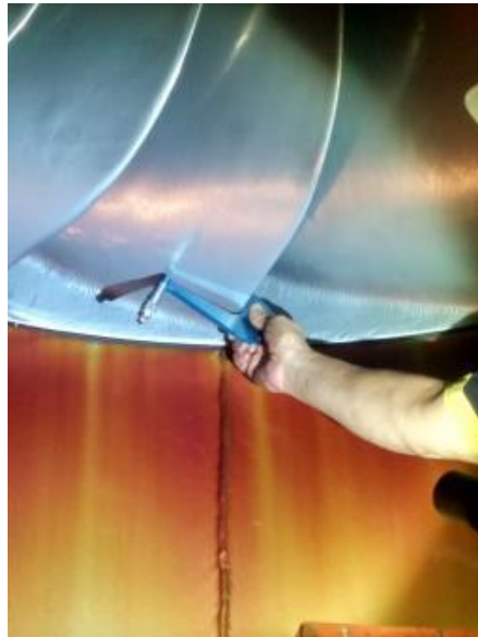
Figura 76. Medición de espesores de álabes del rodete con micrómetro de exteriores
