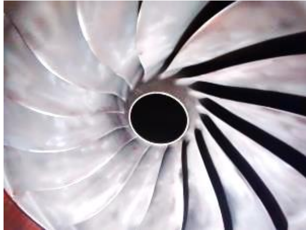
Figura 74. Ensayo no destructivo, aplicación de revelador
