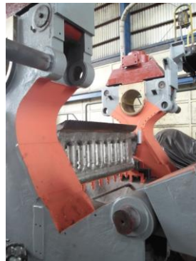
Figura 49. Montaje de chumacera de maza superior en la virgen
