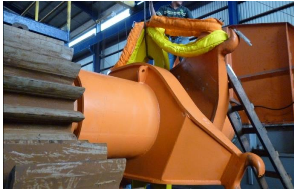
Figura 70. Eslingas de trabajo ubicadas correctamente sobre las eslingas de seguridad en los enganches de elementos de sistema de acople flexible
