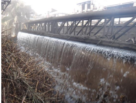
Figura 8. Limpieza de caña utilizando agua en mesa receptora
