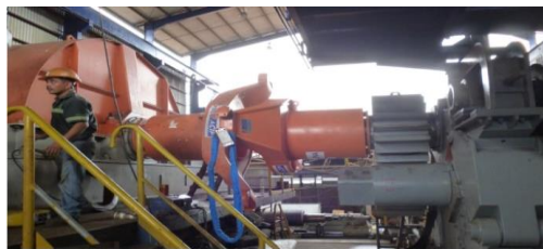
Figura 66. Elementos conductor y conducido de sistema de acople flexible montados en eje de reductor y eje de maza superior de molino respectivamente
