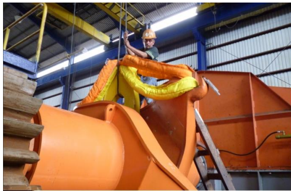
Figura 69. Eslingas montadas en enganches de elementos conductor y conducido de sistema de acople flexible
