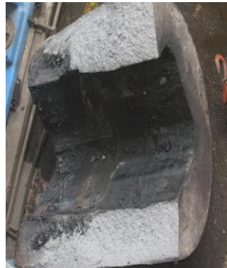
Figura 64. Maza de sistema de acople rígido quebrada debido a fatiga
