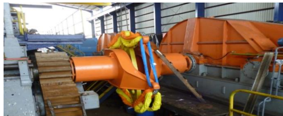
Figura 74. Sistema de acople flexible listo para operación de molino
