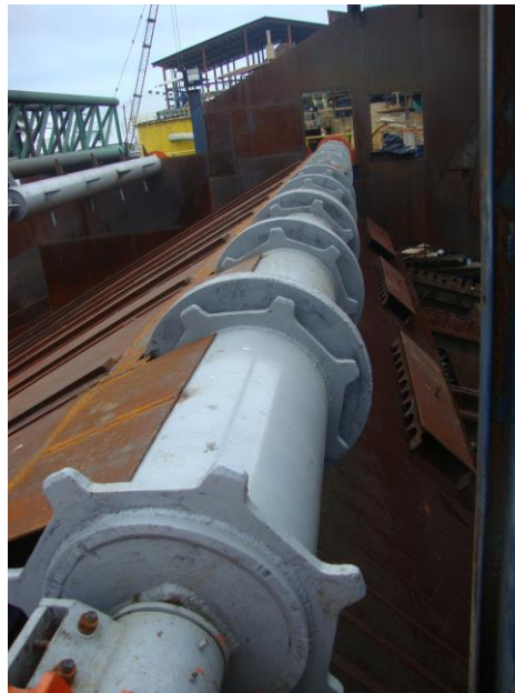
Figura 23. Eje Motriz de mesa receptora
