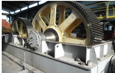
Figura 57. Reductor de baja Walkers utilizados en molinos cañeros de tándem C de Ingenio Magdalena S.A.
