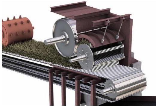
Figura 37. Esquema de operación de rodo alimentador, desfibradora y yunque
