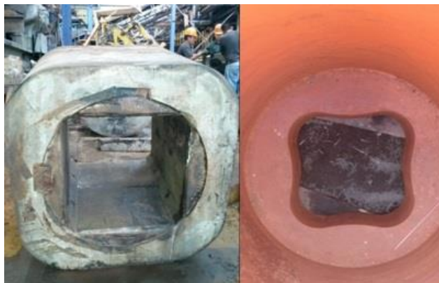
Figura 76. Comparacion de desgaste entre los elementos de sistema de acople rigido y sistema de acople flexible
