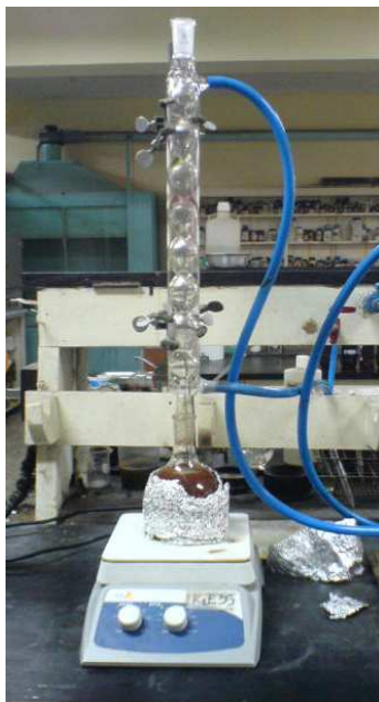
Figura 19. Sistema de maceración dinámica con reflujo
