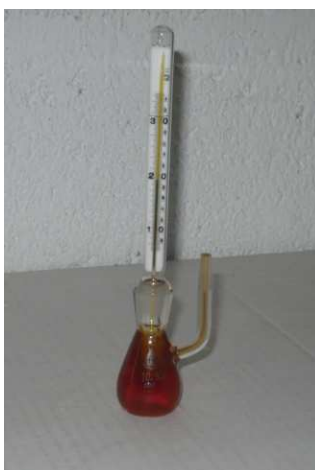
Figura 30. Determinación de la densidad del extracto tintóreo
