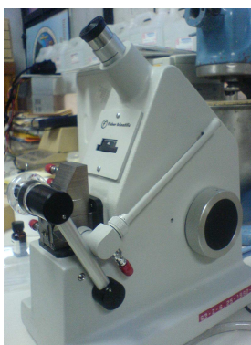
Figura 31. Determinación del índice de refracción del extracto tintóreo
