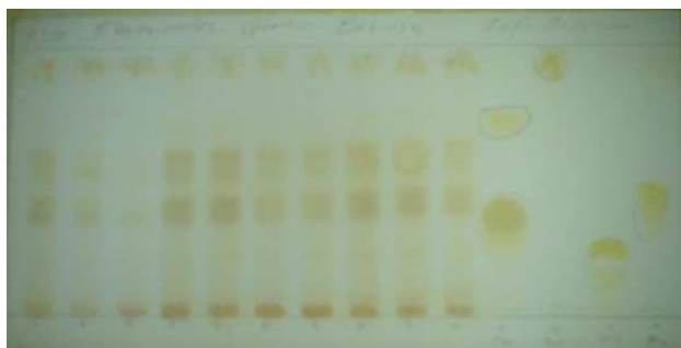
Figura 29. Cromatografía en capa fina para la determinación de flavonoides
