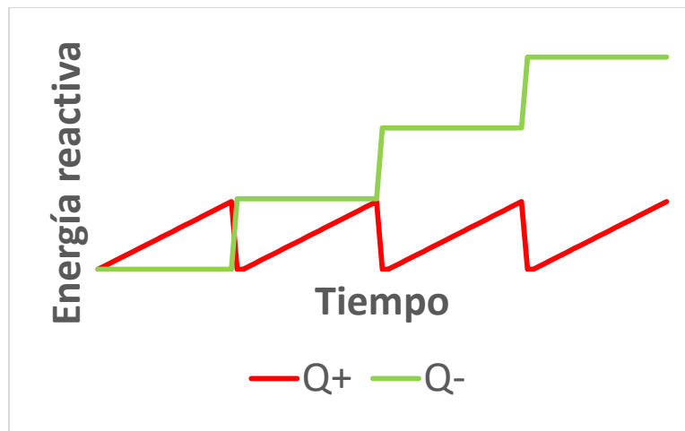
Figura 9. Curva de energía reactiva con compensación escalonada
