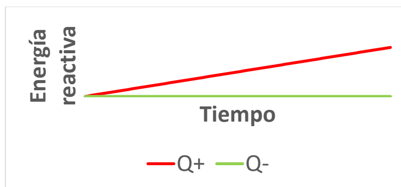
Figura 8. Curva de demanda de energía reactiva sin compensación
