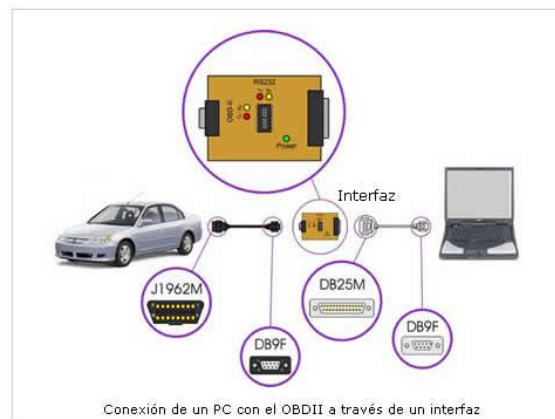
Figura 48. Esquema eléctrico de un interfaz OBDII
