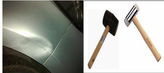
Figura 8. Abolladura leve en un vehículo y martillos blandos
