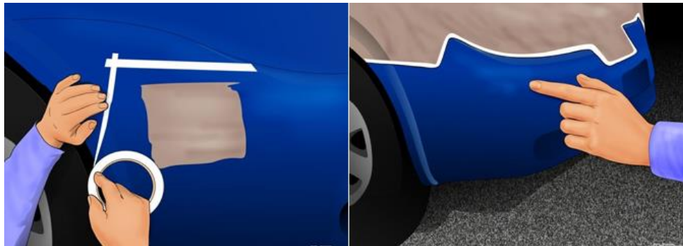
Figura 9. Protección de las superficies que no se trabajarán
