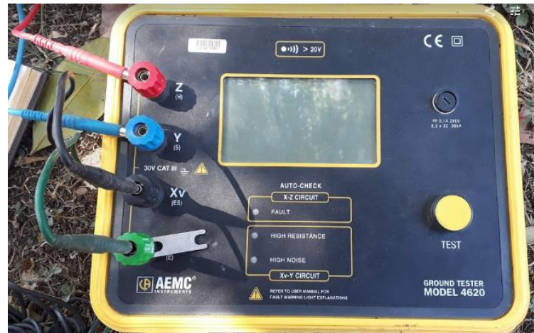
Figura 64. Telurómetro utilizado para medición de resistividad de suelo
