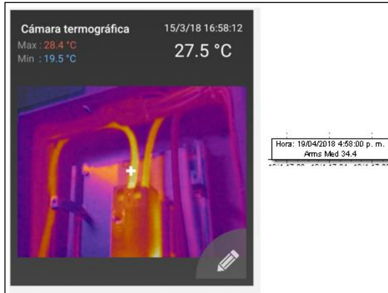
Figura 35. Medición de temperatura y corriente
