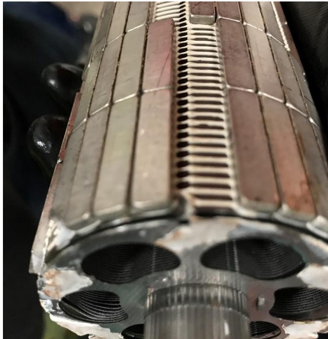
Figura 15. Rotor con imanes de neodimio
