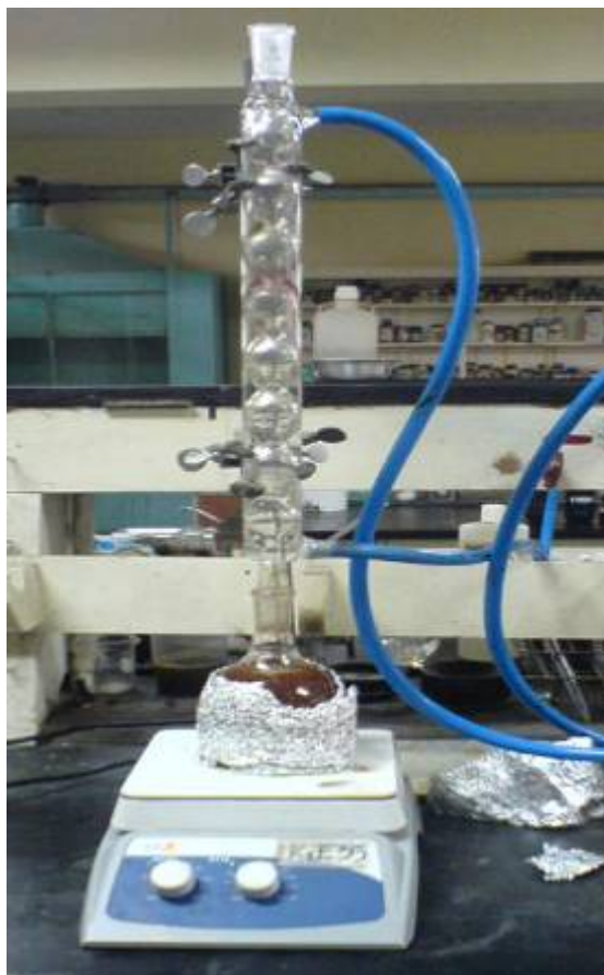
Figura 23 Equipo de lixiviación con reflujo en funcionamiento
