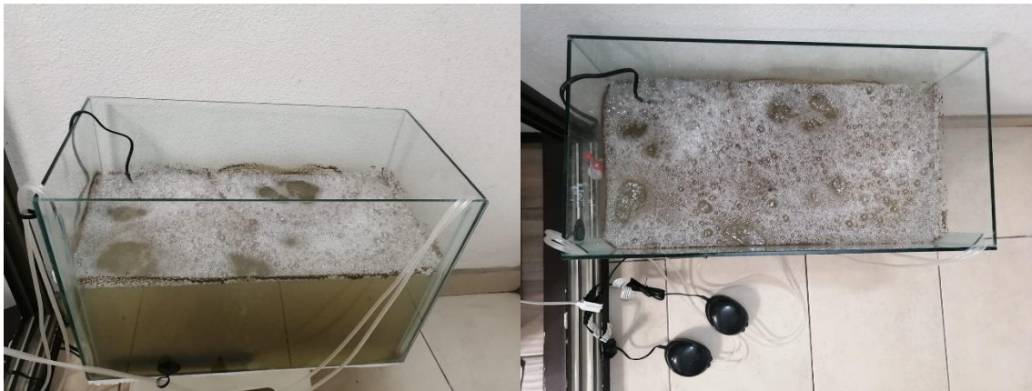
Figura 12. Funcionamiento del reactor biológico aerobio (SBR) piloto
