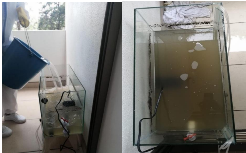
Figura 11. Llenado de reactor biológico aerobio (SBR) piloto
