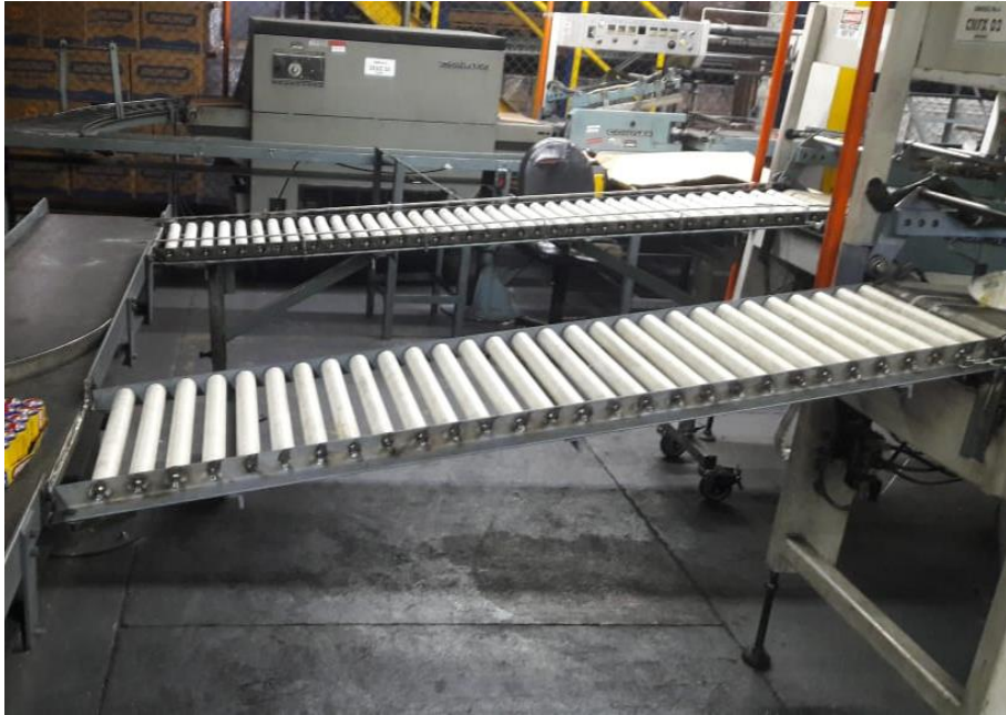
Figura 43. Fase 3 Instalación de los rapistanes en embandejadoras automáticas
