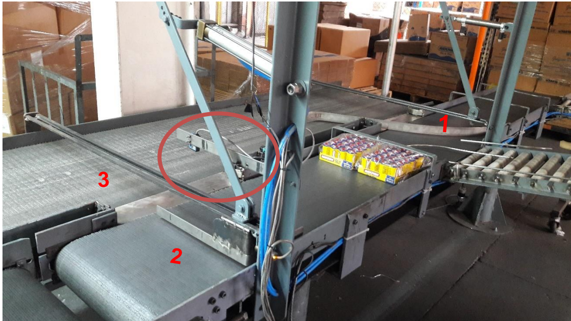
Figura 48. Funcionamiento del mecanismo empujador de bandejas
