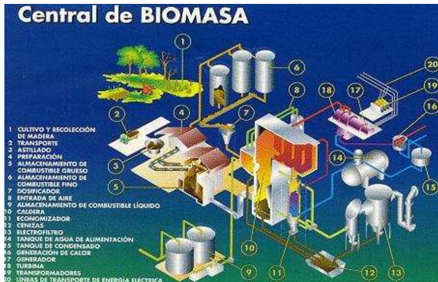
Figura 12. Diagrama de proceso de una central de generación eléctrica a partir de biomasa
