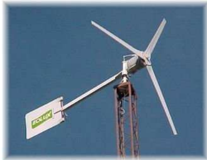
Figura 7. Miniturbina eólica de uso domestico
