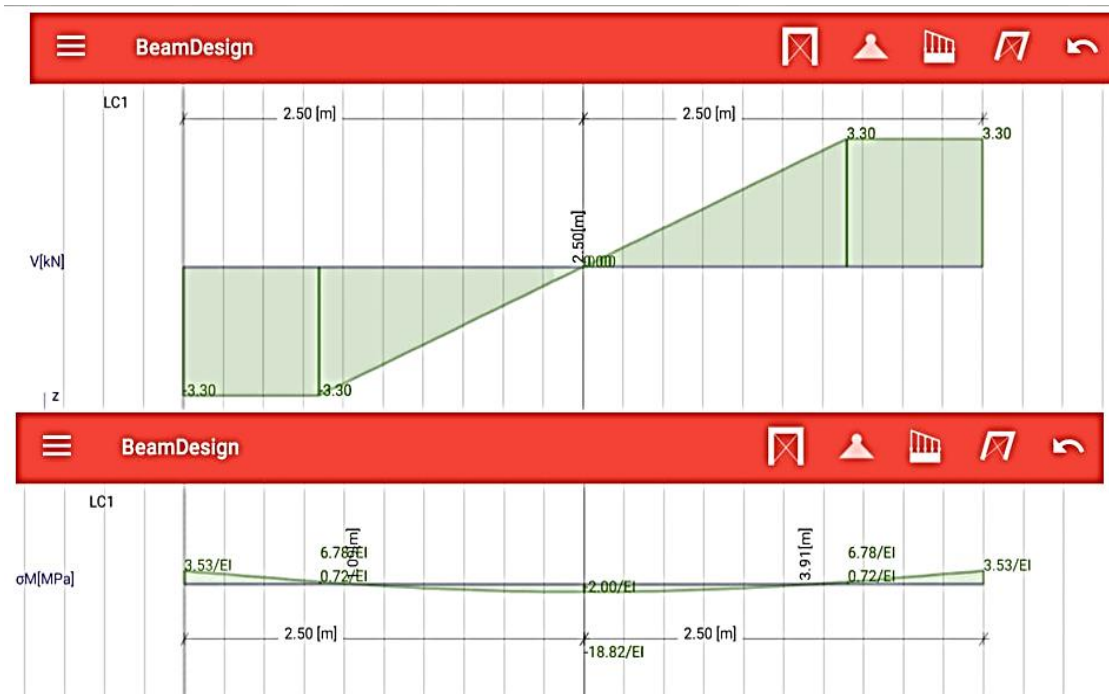
Figura 7. Ejercicio 2, diagramas de viga doblemente empotrada
