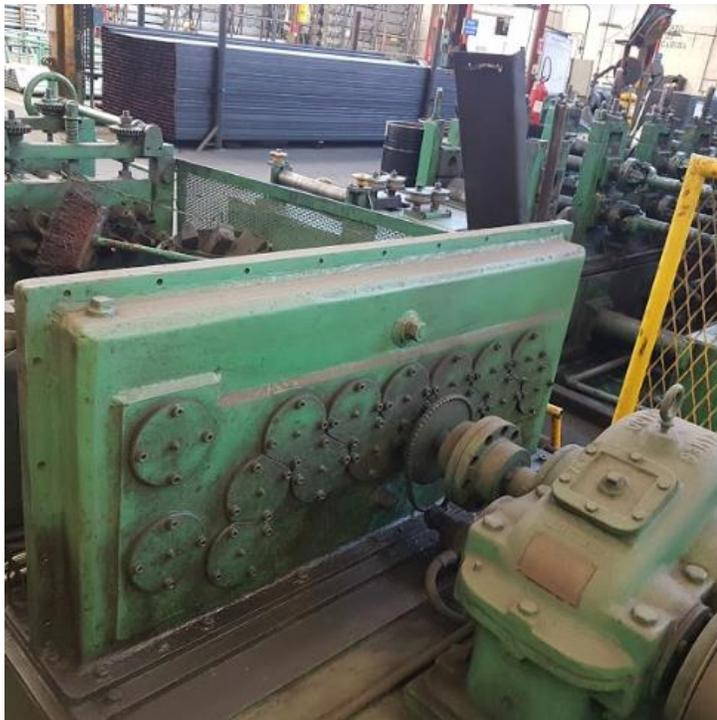
Fuente: Industria de Tubos y Perfiles S.A. *Caja reductora de líneas de formado*.
