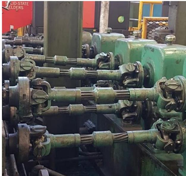
Fuente: Industria de Tubos y Perfiles S.A. *Eje de transmisión con juntas cardan.*
