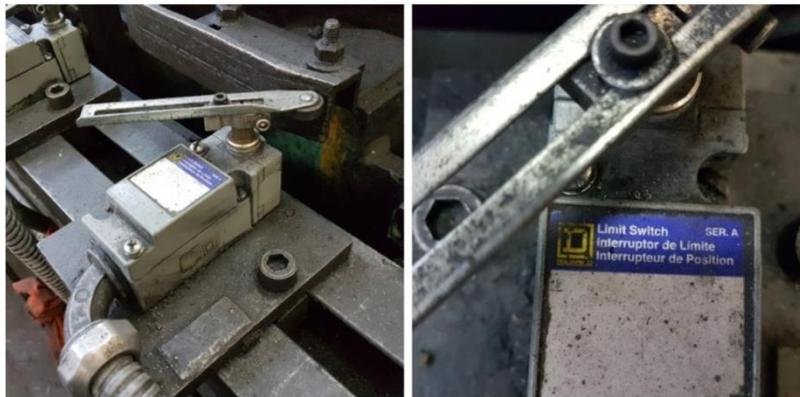
Fuente: Industria de Tubos y Perfiles S.A. *Interruptores de límite de carro de corte hidráulico*.
