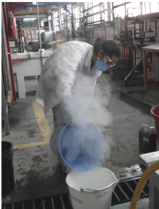
Figura 38. Momento en el que se agrega la solución de H_2SO_4 al lote de hematita.
