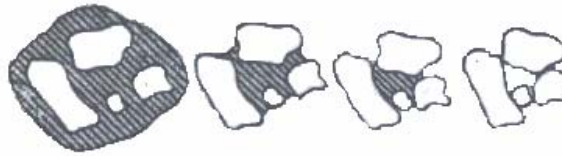
Figura 9. Etapas en la desecación de una pasta de arcilla-agua (Norton). La pérdida de agua eleva la capacidad y la acción mutua entre las partículas
