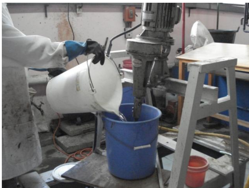
Figura 38. Momento en el que se agrega la solución de H_2SO_4 al lote de hematita.
