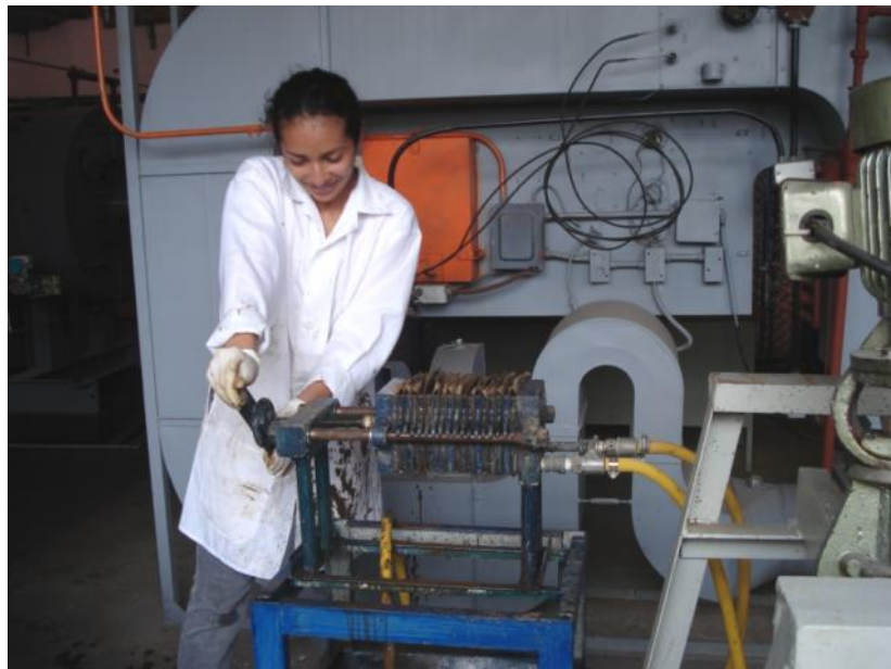
Figura 40. Aseguramiento de las placas del filtro prensa.
