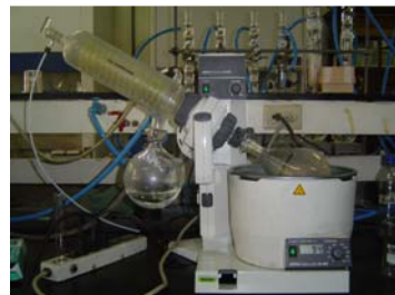
Figura 9. Rotavapor, Laboratorio Química Industrial
