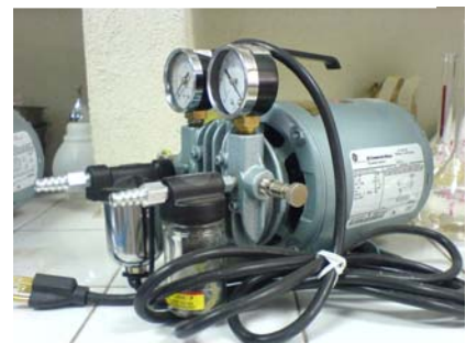
Figura 6. Bomba de vacío, Laboratorio Química Industrial
