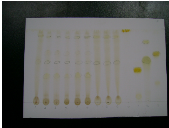
Figura 18. Cromatografía en capa fina de los extractos colorantes acuosos y etanólicos obtenidos del exocarpo del coco ( Cocos nucifera ).
