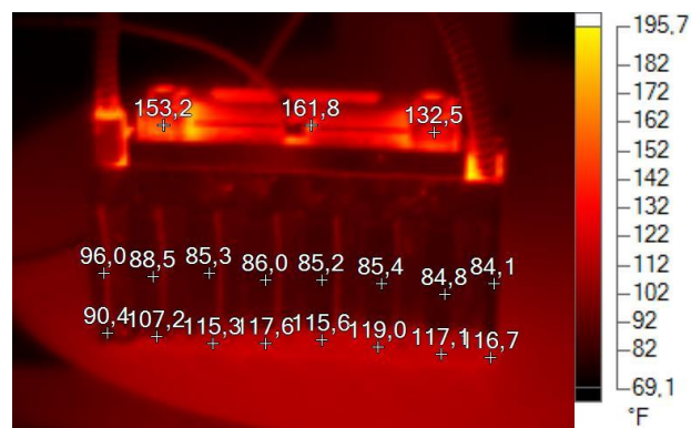
Figura 42. Imagen termográfica de moldes ranurados para blísteres
