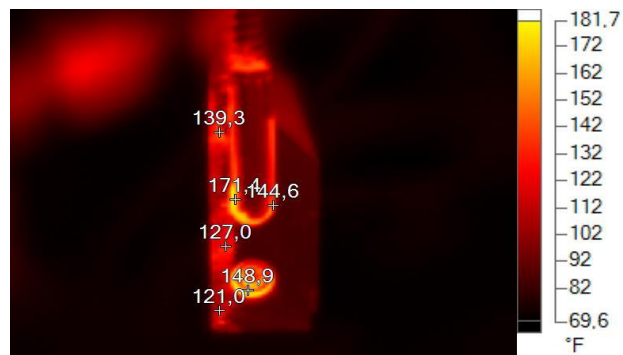
Figura 46. Imagen termográfica de molde de blísteres viste lateral
