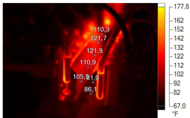
Figura 48. Imagen termográfica moldes de blíster ubicados en máquina de soplado
