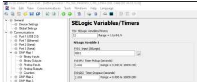
Figura 163. Lógicas de automatización del SEL-2440
