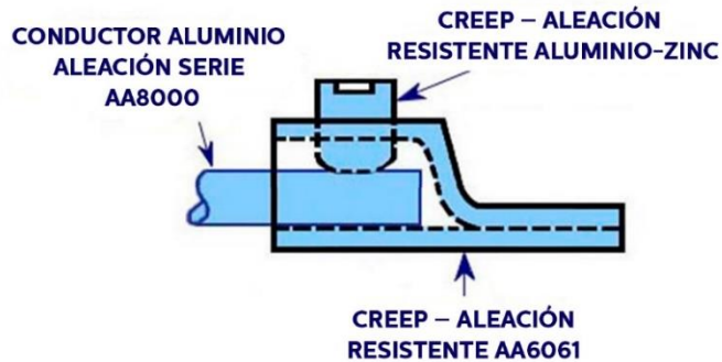
Figura 8. Conexión de doble clasificación UL AL-Cu
