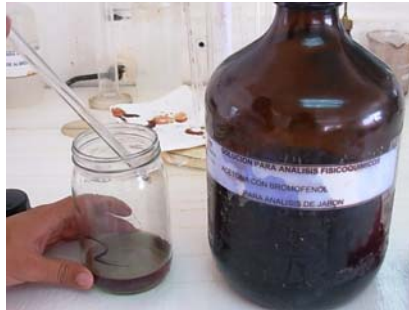
Figura 18 Preparación de reactivos para la determinación del contenido de jabón en el aceite de café
