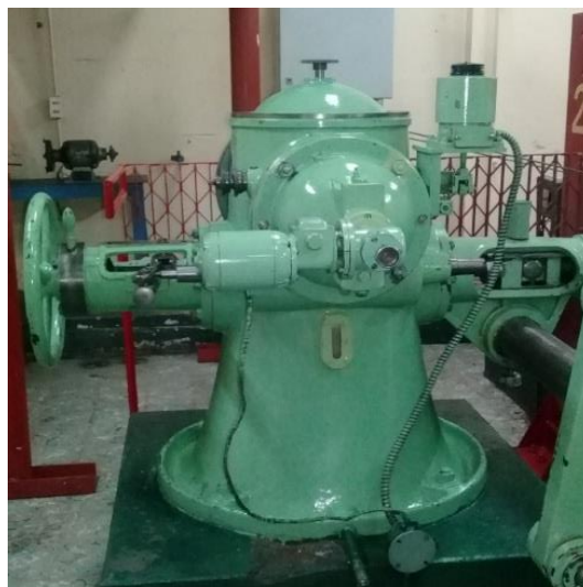
Figura 37. Nivel de aceite, regulador de velocidades
