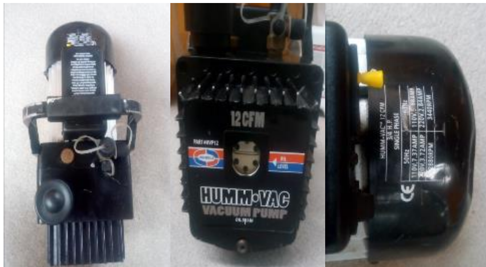
Figura 8. Bomba de vacío, equipo utilizado para la experimentación del presente estudio
