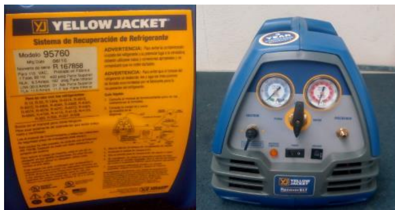
Figura 6. Recuperadora de gas refrigerante empleada en el presente estudio
