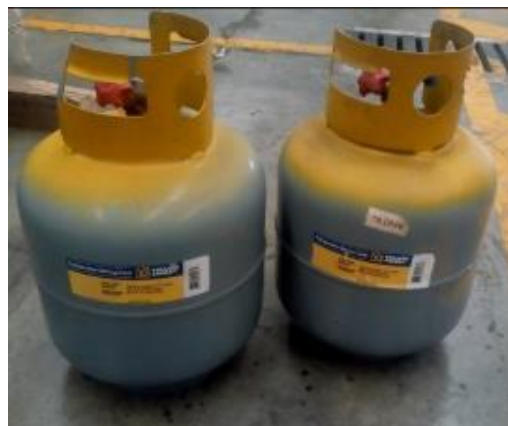
Figura 7. Cilindros para recuperación de gases refrigerantes, equipo empleado en la experimentación del presente estudio
