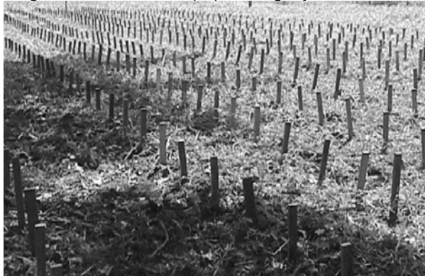
Figura 5. Métodos de campo para hongos y termitas
