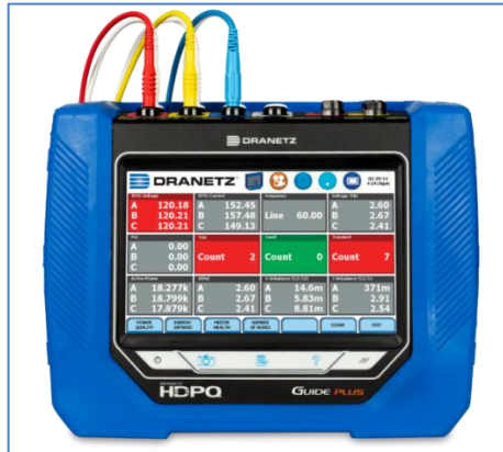
Figura 40. Medidor de calidad de energía Dranetz HDPQ Guide
