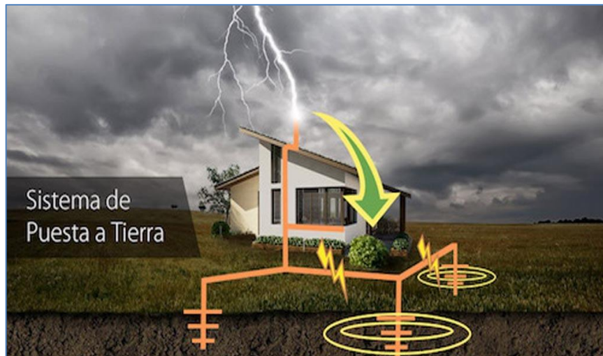
Figura 28. Sistema de puesta a tierra
