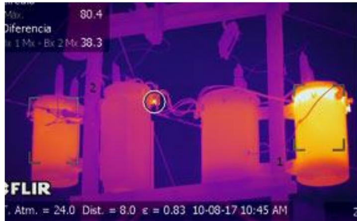
Fuente: Infratermic. *Termografía de un transformador sobrecalentado.*
