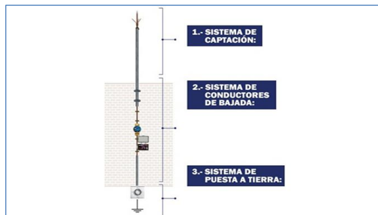
Figura 24. Instalación de un pararrayos
