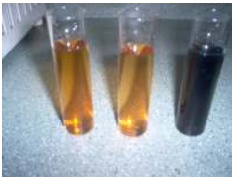
Figura 3. Comparación de soluciones de extracto tánico con y sin \text{FeCl}_3 .
