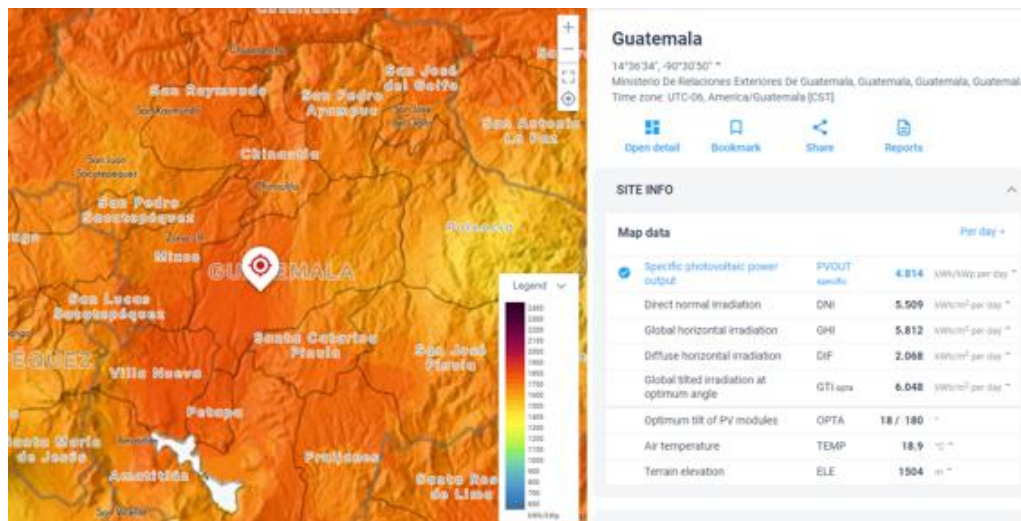
Figura 126. Irradiación global horizontal (GHI) para el Minex
