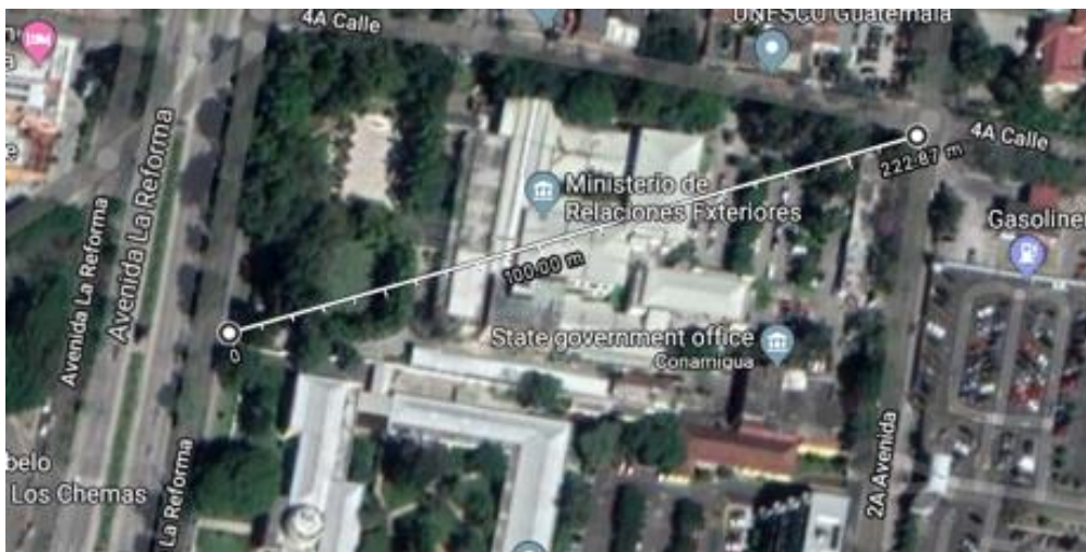
Figura 118. Proyección de cobertura del pararrayos
