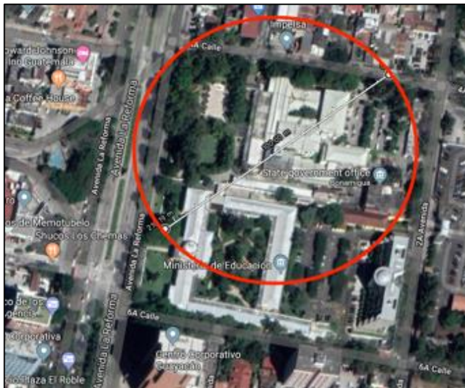
Figura 81. Proyección de cobertura del pararrayos
