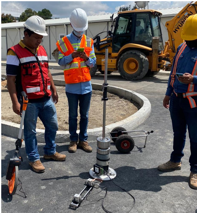
Figura 2. Ensayo de deflectometría con peso ligero
