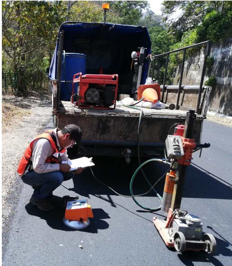
Figura 3. Ensayo de compactación de pavimento asfáltico
