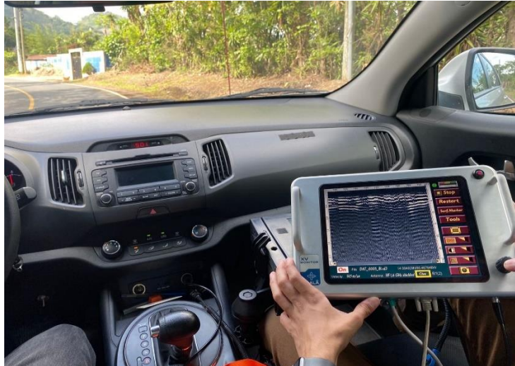
Figura 5. Recopilación de datos con el monitor del georadar
