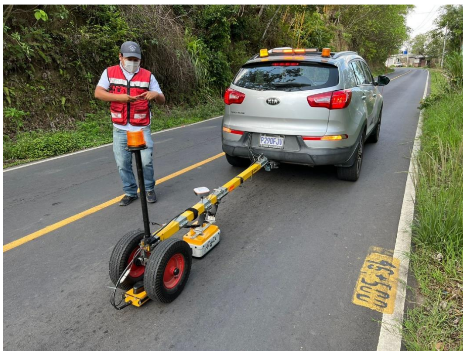
Figura 4. Evaluación de espesores con georadar
