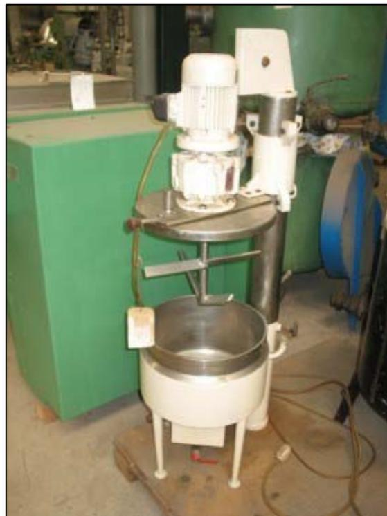
Tanto en la marmita como en el mezclador / emulsionador se requiere un sistema de regulación de temperatura para asegurarnos que la emulsión se produce a la temperatura adecuada.
