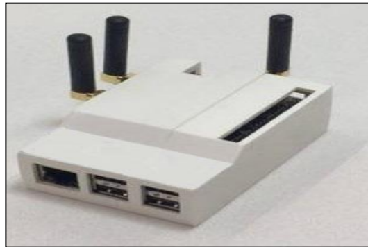
Figura 28. Case adaptado para imprimir en 3D
