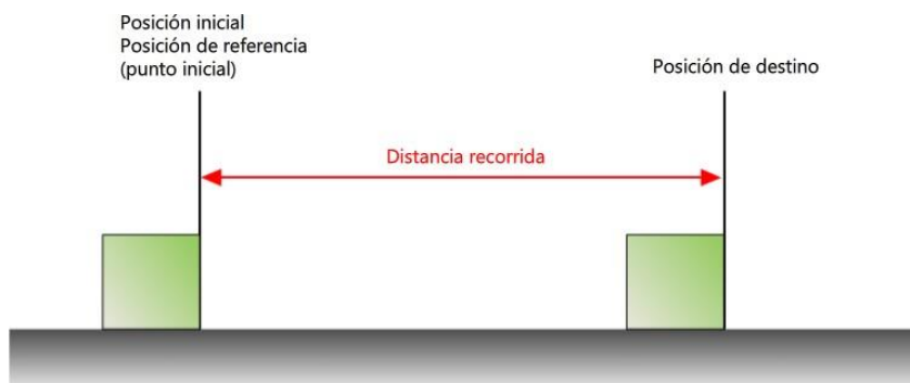
Figura 94. Designación de referencias para control de posicionamiento
