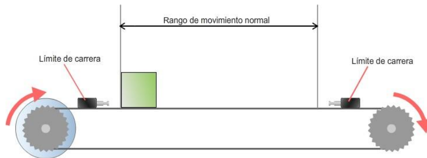
Figura 100. Finales de carrera para prevenir un sobre - impulso
