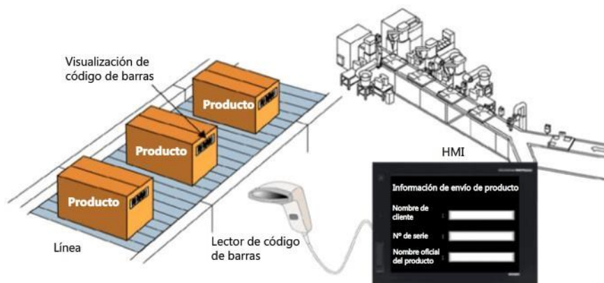
Figura 60. Funcionamiento de una HMI como control de información en la producción
