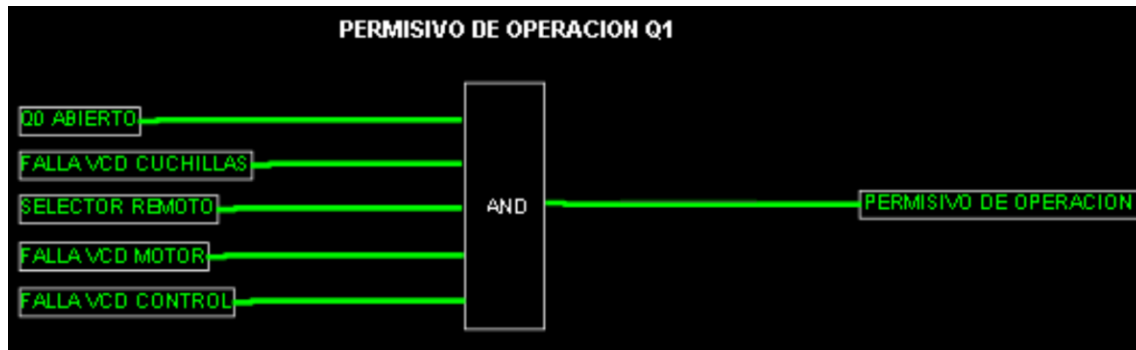
Figura 34. Permisivos de operación remota de seccionador de barra Q1
