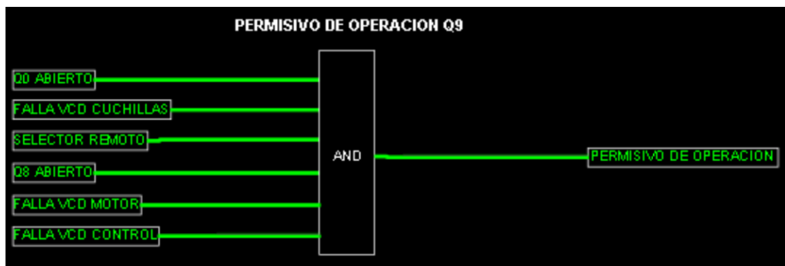
Figura 32. Permisivos de operación remota de seccionador de línea Q9
