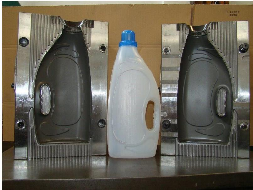
*Nota.* Interior de molde para soplado de envases. Obtenido de Setecproh. (2020). *Molde para soplado de plástico* (<http://setecproh.com/moldes-para-la-industria-del-plastico/>) Consultado el 1 de octubre de 2022. De dominio público.
