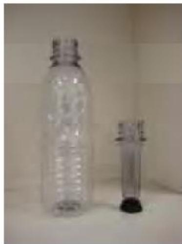
*Nota.* Envase PET y preforma. Obtenido de A. Rodríguez (2009). *Utilización de preformas de PET luego de sufrir un calentamiento accidental en la máquina de soplado.* (p. 12.) Universidad Simón Bolívar.
