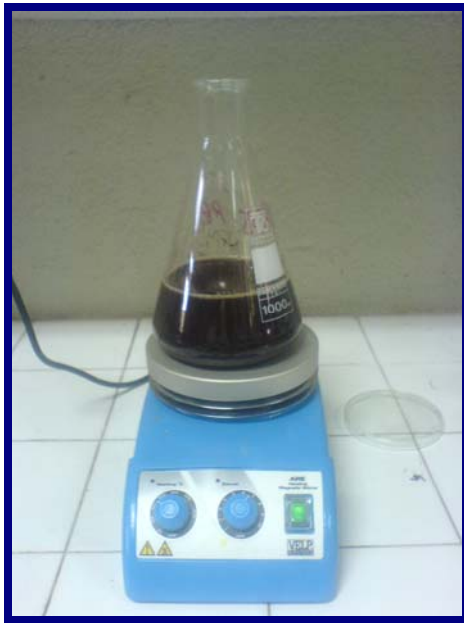
Figura 82 Primera fila-izquierda : Unidad de lixiviación en el proceso. Derecha: maceración dinámica de corteza con solución acuosa de sulfito de sodio al 2%. Segunda fila-izquierda: filtrado de extracto total fluido .Derecha: secado de extractos totales.
