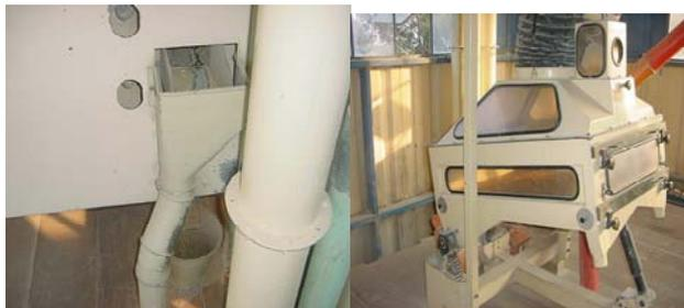
Luego son sometidos al acondicionamiento que consiste en humectar y dejar en reposo el trigo por aproximadamente 24 horas para que el trigo adquiera las condiciones necesarias para ser molidos, (la cantidad de agua y el tiempo de reposo dependen de las características de dureza del grano). Este procedimiento se realiza para facilitar la separación del salvado, separación del endospermo y la pulverización de los granos de trigo.
