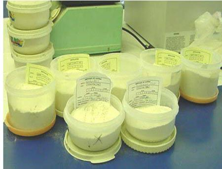
Muestras de harina son llevadas al laboratorio de distintos puntos del proceso para monitorear la calidad de la harina. Se analiza una muestra de harina sin aditivos o virgen, una muestra de la salida de la banda transportadora de aditivos que es un tornillo sin fin que mezcla los aditivos y una muestra de la harina de la tolva a la salida del empaque.
