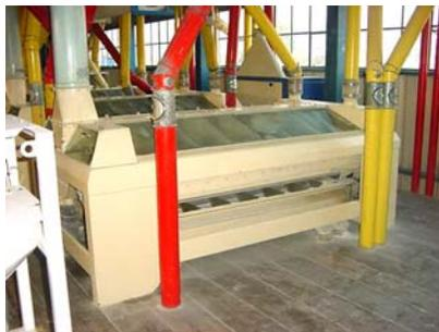
El sistema de compresión y cernido, mediante cilindros, tiene como objeto moler las sémolas y semolines purificados para transformarlas en harina.
