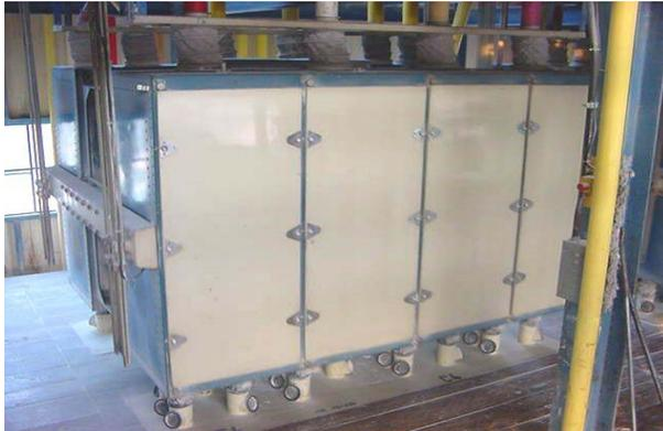
La sémola impura se envía a los sasores para ser purificada. Después de efectuada la trituración, es necesario realizar una reducción de la sémola (es el endospermo obtenido en las primeras trituraciones), y harinilla, que es la harina extraída de la parte superior del endospermo para dar lugar a la harina, mediante proceso de reducción de las partículas y eliminación de cubiertas.
