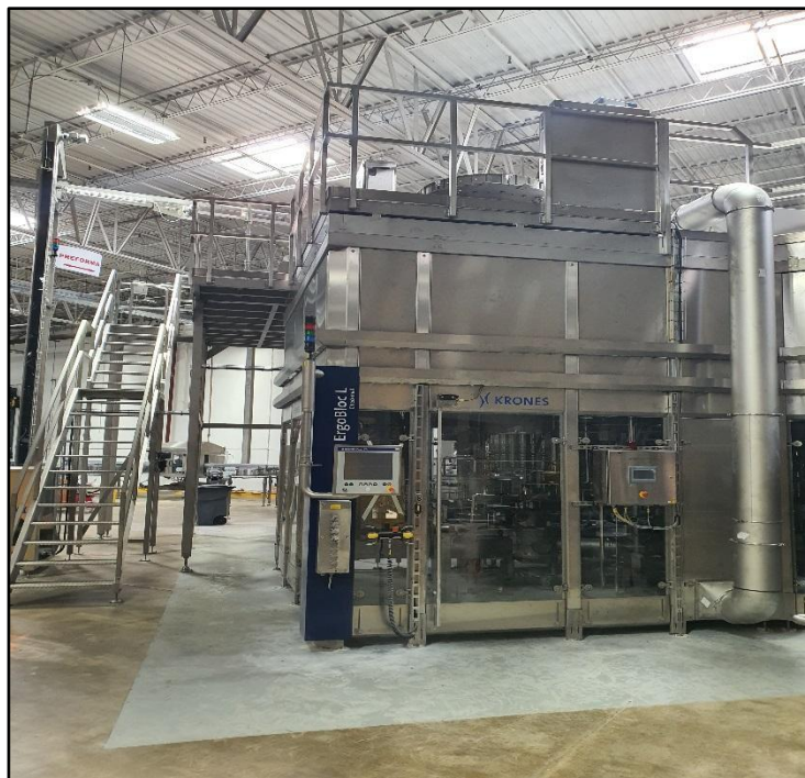
Figura 43. Taponadora para botellas PET marca Krones
