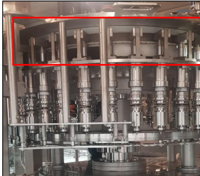
Figura 50. Pista de rodadura de la leva elevadora
