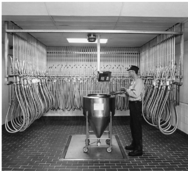
Figura 2. Sistema de producción de sabores por lotes en planta industrial
