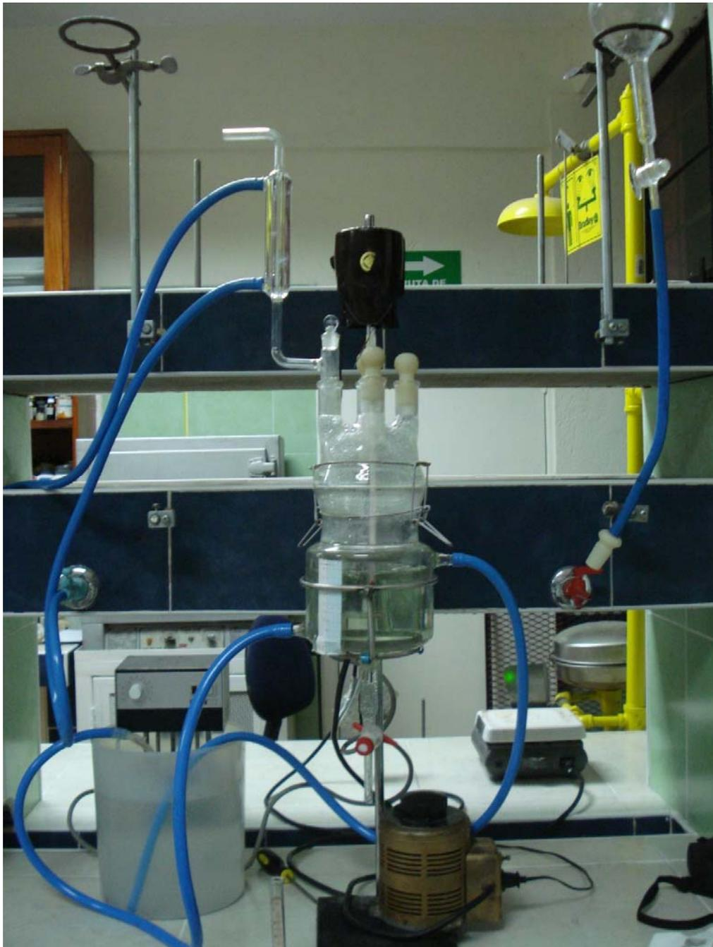
**Figura 89** Equipo para monitorear la cinética de hidrólisis ácido, junto a los balones que muestran la formación de Ortofosfato, aumentando la intensidad del color amarillo
