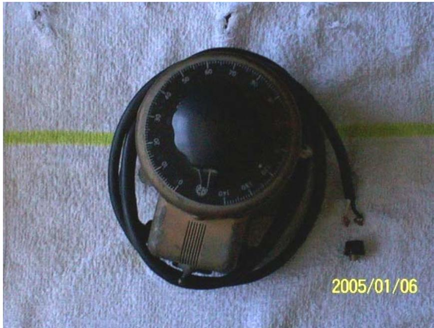
**Figura 78** Reóstato después de la calibración, pintado y reparación eléctrica
