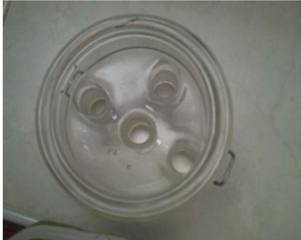
**Figura 72** Construcción de una turbina de disco con 6 palas en ertalón, y 6 tapones 24/40 de ertalón, 5 con apertura central ajustada, para introducir el termómetro, el eje de agitación, dosificar reactivos y uno para sellar
