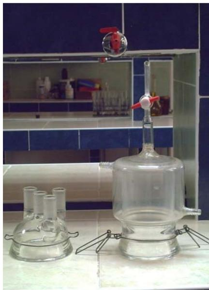
**Figura 71** Adaptación de un empaque de teflón para el cierre hermético cuerpo y la tapadera del reactor
