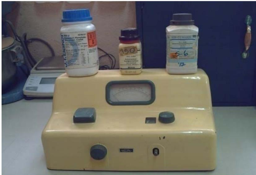
**Figura 84** Espectrofotómetro Rochester de Bausch and Lomb después de reparar, la perilla de control de la intensidad luminosa
