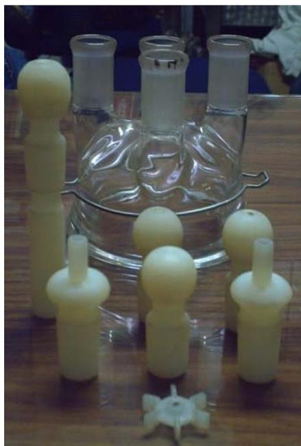
**Figura 73** Diseño y construcción de un sistema de baffles, para evitar vórtices y aumentar la turbulencia dentro del reactor
