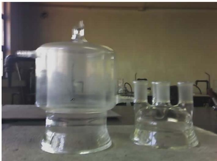
**Figura 68** Adaptación de una pieza de vidrio con llave de teflón para toma de muestras
