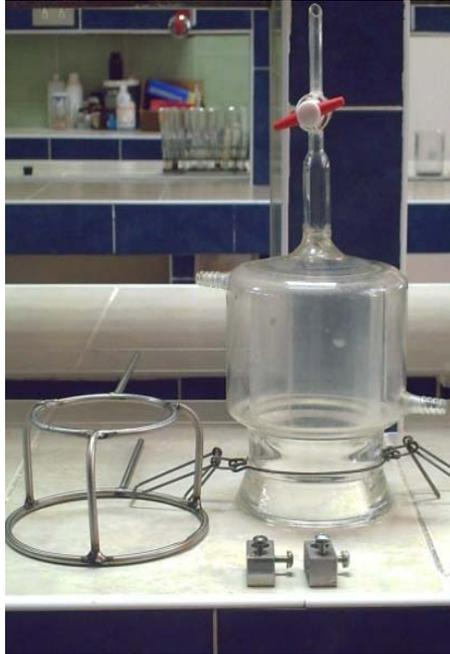
**Figura 70** Diseño y construcción de un sistema de sujeción de acero inoxidable, para apertura y cierre hermético entre el cuerpo y la tapadera del reactor
