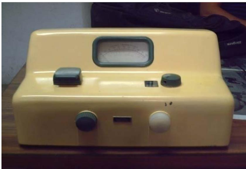
**Figura 85** Espectrofotómetro Rochester de Bausch and Lomb, con la nueva lámpara instalada para su posterior uso
