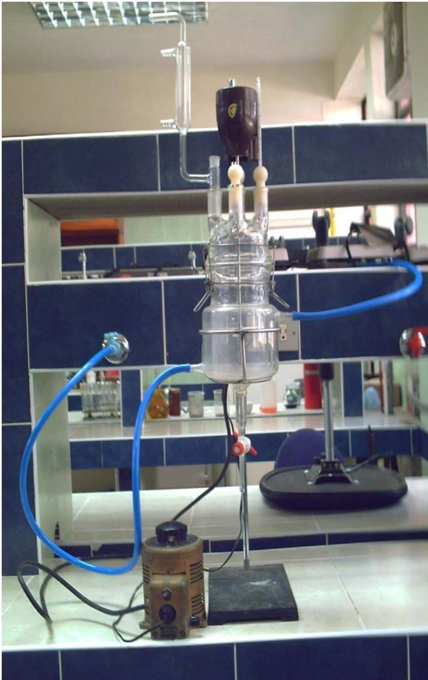
**Figura 88** Reactor tipo tanque con agitación (CSTR) discontinuo, en fase de operación
