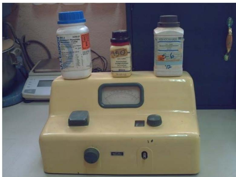
**Figura 81** Carcasa metálica del espectrofotómetro Rochester de Bausch and Lomb antes de pintarse
