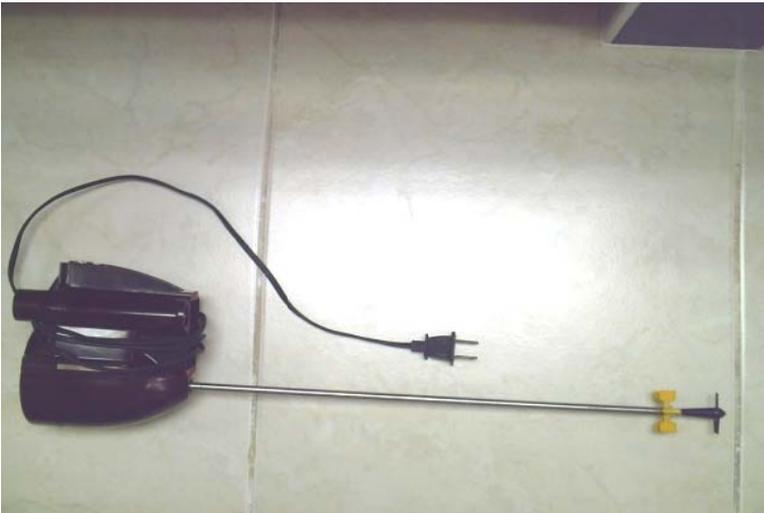
**Figura 77** Reóstato antes de la calibración, pintado y reparación eléctrica
