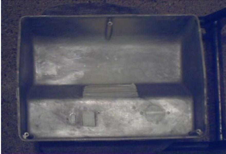
**Figura 82** Carcasa metálica del espectrofotómetro Rochester de Bausch and Lomb después de pintarse
