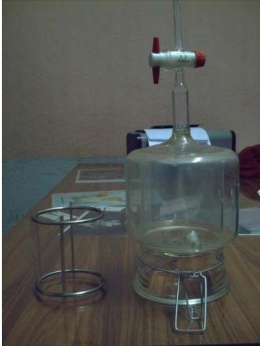
**Figura 74** Vista del sistema de baffles dentro del reactor
