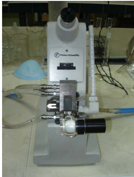
Figura 39 Detalle de la unidad de medición de índices de refracción a la temperatura de 23 ° C.
