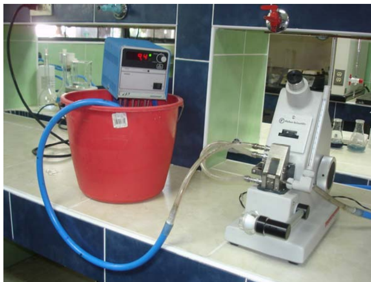
Figura 40 Detalle de la unidad de medición de índices de refracción a la temperatura de 10 ° C.
