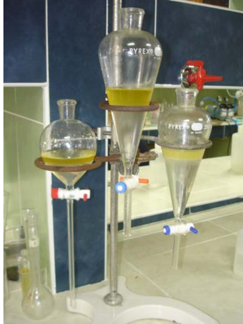
Figura 43 Detalle de la unidad de separación de las fases de las mezclas ternarias luego de la agitación.
