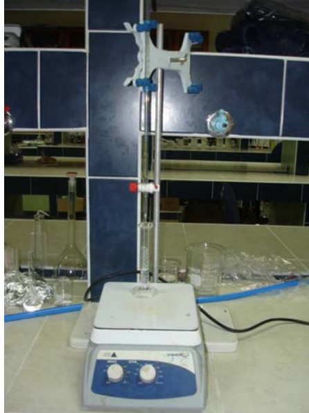
Figura 41 Detalle de la unidad utilizada para la titulación de las mezclas binarias a la temperatura de 23 ° C.
