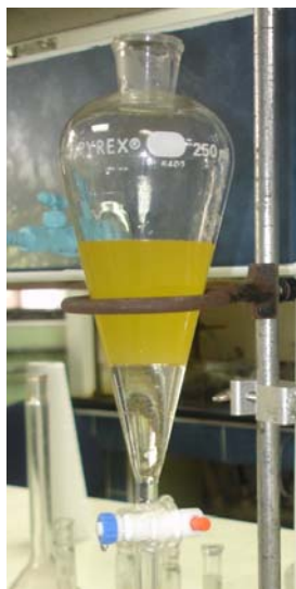
Figura 44 Detalle de las fases de extracto y refinado durante el proceso de separación.
