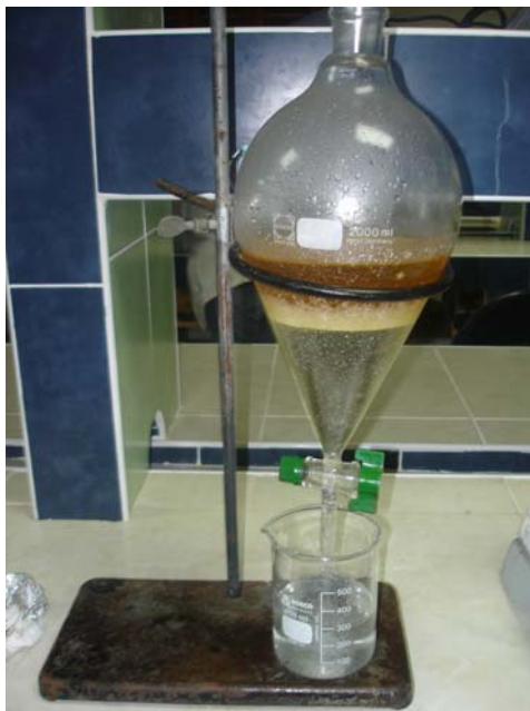
Figura 36 Detalle de la unidad de separación del agua de lavado del biodiesel
