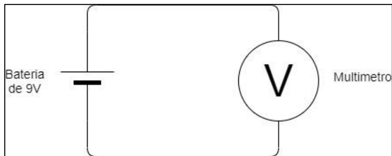
Figura 81. Circuito para la medición de una fuente de voltaje directo
