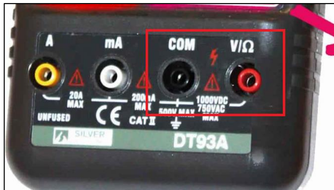
Figura 79. Conectores de un multímetro digital, voltaje
