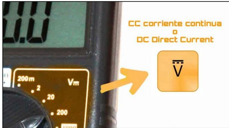
Figura 80. Sección de voltaje en multímetro digital
