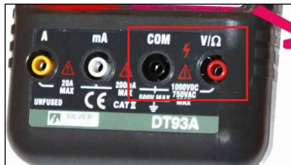
Figura 76. Conectores de multímetro digital
