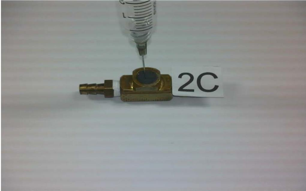
**Figura 50. Conector reactivos, consistente en dos niples de bronce 1/8 plg, unión universal y un niple de bronce 1/4 plg.**
