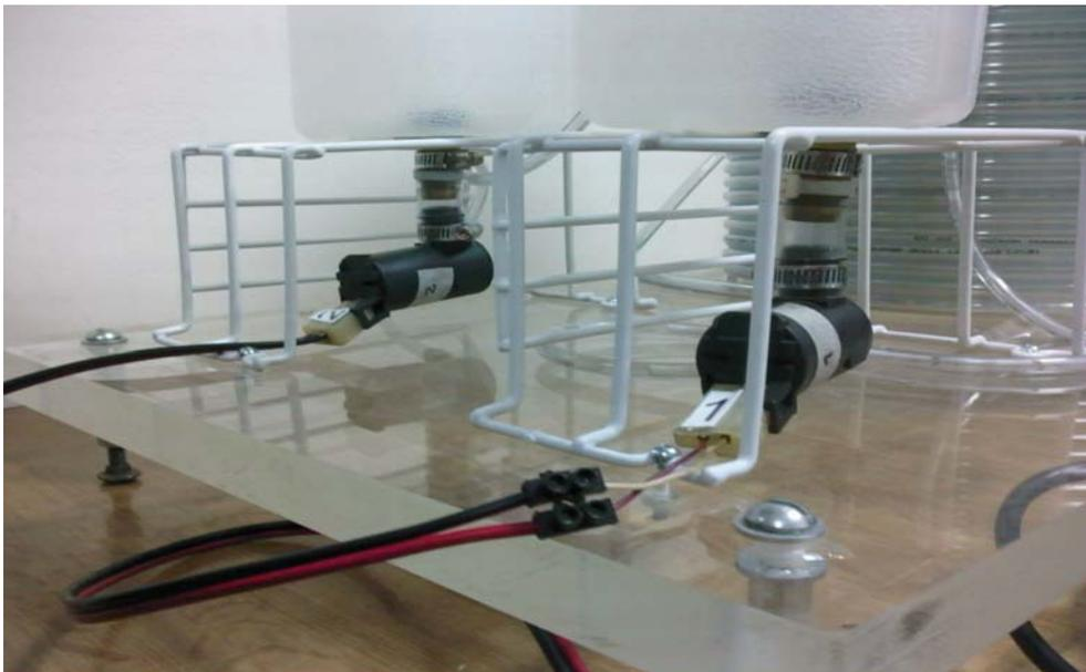
Figura 65. Fotografía frontal del reactor tubular construido
