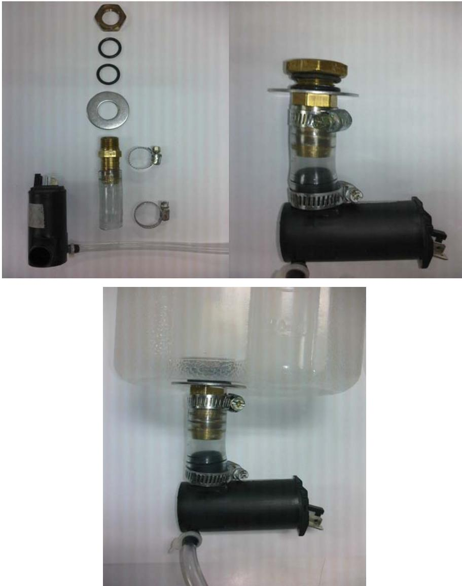
Figura 53. Sistema de bombeo del reactor tubular
