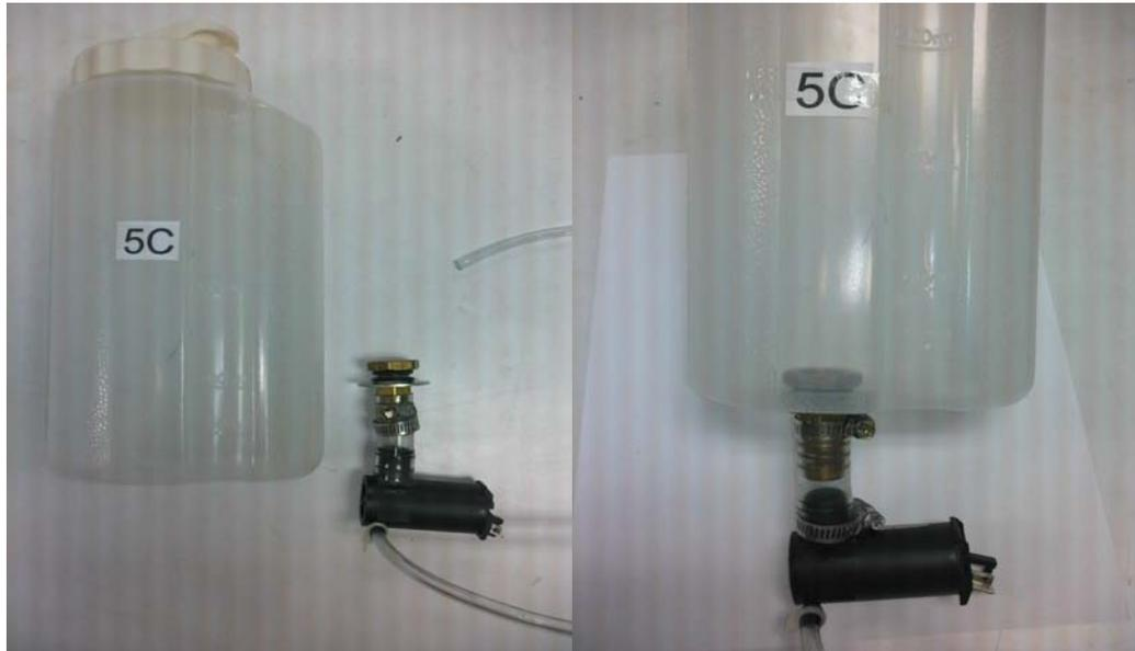
**Figura 52. Detalles de sellado de bomba centrífuga de 12 V utilizada en el reactor tubular**
