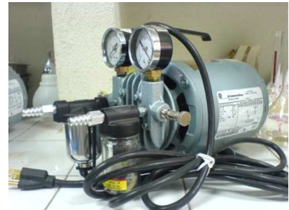
Figura 3. Bomba de vacío
